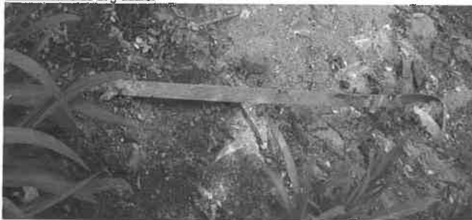
Foto 23. Platbanda OL-Zn corodat
